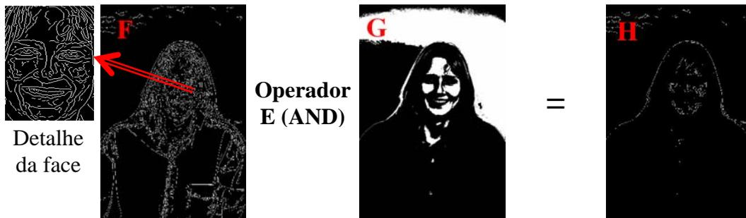
Figura 4 - Aplicação do filtro de bordas (F) com detalhe da face. Filtro de pele (G). Pontos borda-pele (H).
