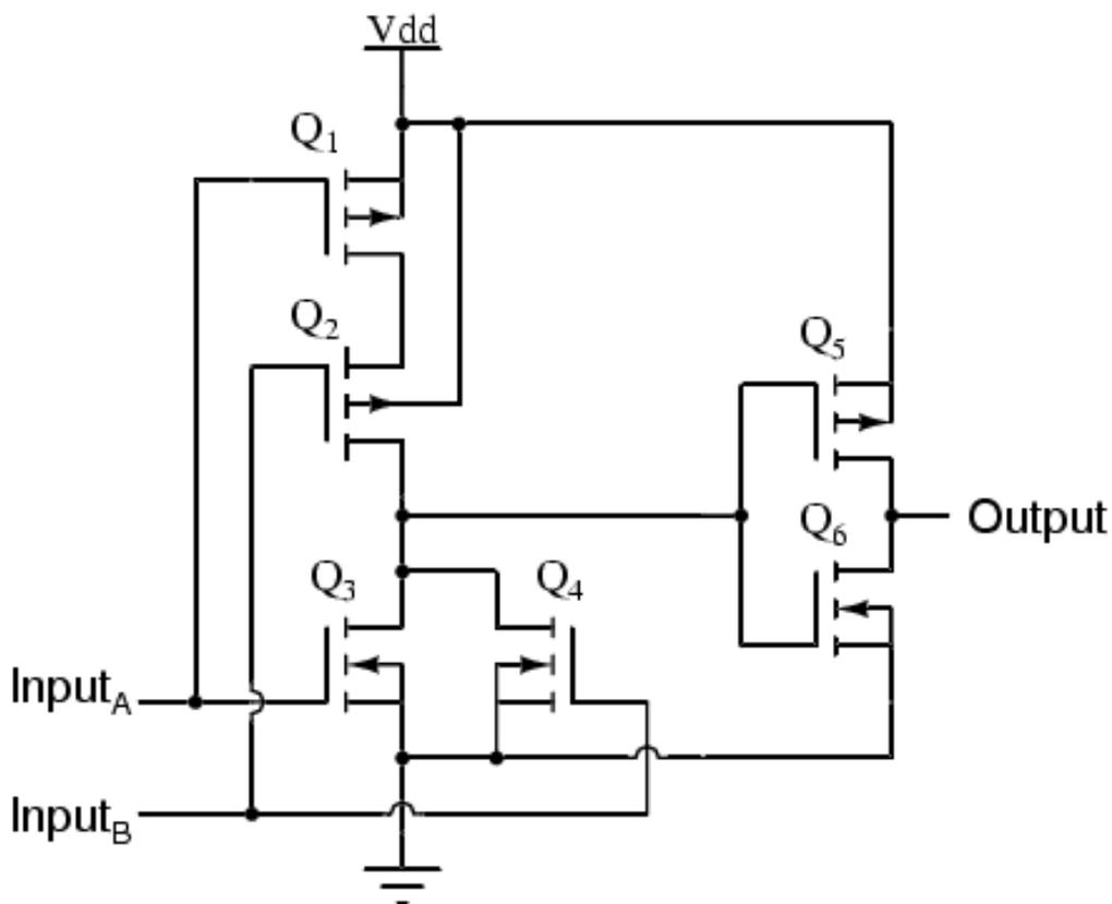
a) Considerando que as entradas podem ser 0V (Nível lógico 0) e 5V (Nível Lógico 1), encontre a função lógica que este circuito implementa, preenchendo a tabela abaixo com **ON** para ligado e **OFF** para desligado (2.5 pontos):
