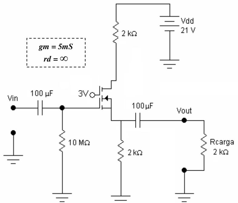
d) Se a tensão fixa de 3V no gate 2 fosse diminuída para zero, o circuito funcionaria adequadamente como amplificador? Justifique sua resposta. (1 ponto)
